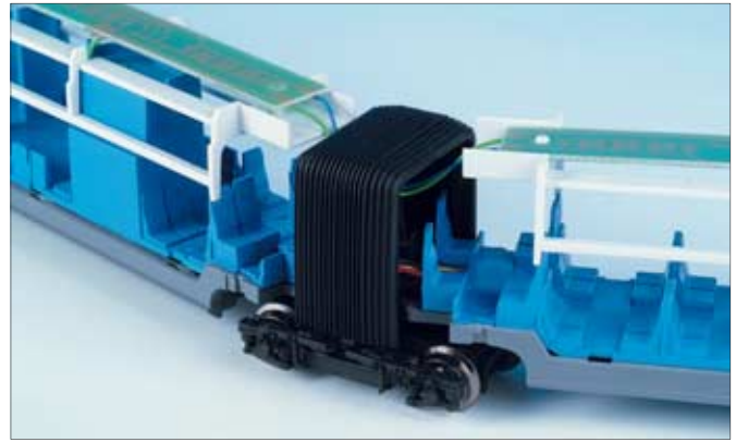
Am Jakobsdrehgestell werden die beiden Fahrzeugteile jeweils mit eigenen Kurzkupplungskulissen angelenkt. Die elektrische Verbindung erfolgt über sehr flexible Litzen. Fotos: MK
